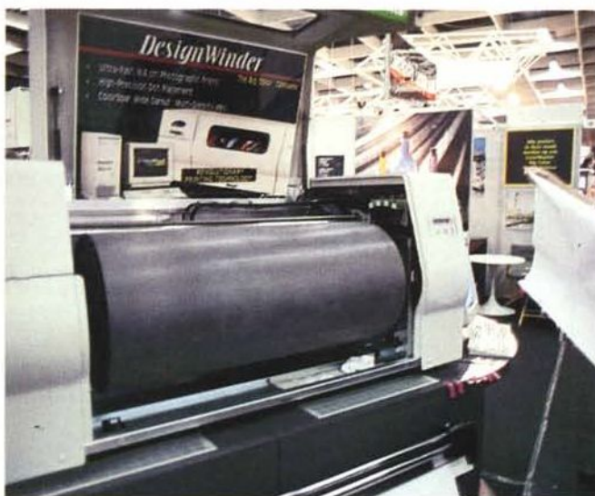
Sembra un gigantesco scanner a tamburo e invece è una innovativa stampante a getto di inchiostro su... tamburo.
